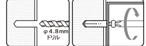
市販のコンクリートプラグをご使用ください。コンクリートドリルで穴をあけ、プラグを打ち込み、木ネジで固定します。
