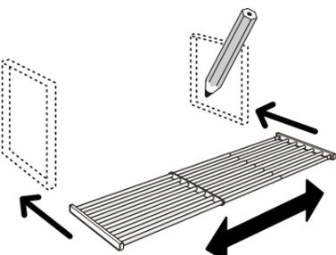
棚板を取り付けたい幅に広げて、取付位置に目印を付けてください。棚板の外幅が枠の外幅になります。(伸縮幅90~120cm)
