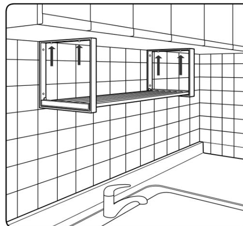
吊り戸棚の底面に下穴をあけ、市販のボルト・ワッシャー・ナットで枠の上部を固定します。
