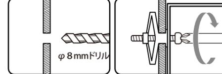
市販のボード用アンカーをご使用ください。ドリルで下穴をあけ、アンカーを差し込み、ネジをしめるとアンカーが開いて固定できます。
