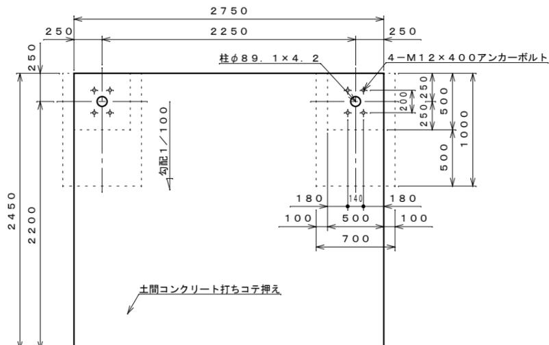
基礎伏せ図 S=1:30 [注: この基礎は標準を示しています。現場の実情に合わせて、ご設計下さい。]
