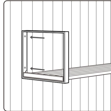
付属の 木ネジで板壁・木質新建材・合板などに取付けられます。
