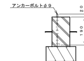
アンカーボルト埋設図 S=1:10
