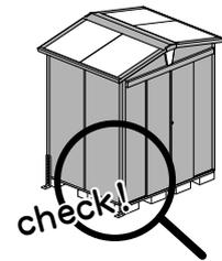
組立完了後、ボルトのゆるみや金具類の付け忘れがないか、確認してください。正しく組み立てられていないと、所定の強度が確保できなくなります。
