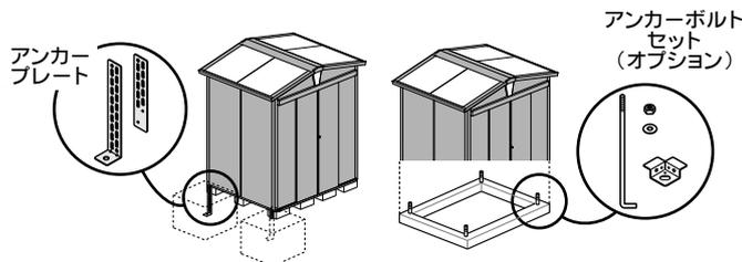
転倒予防のために、所定の基礎打設作業を必ず行ってください。台風などの強風時に転倒し、重大なケガや収納物に損害を与える恐れがあります。
