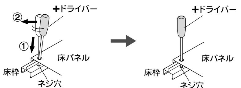
(注意) ネジ穴のネジがつぶれないように注意して取り付けてください。
