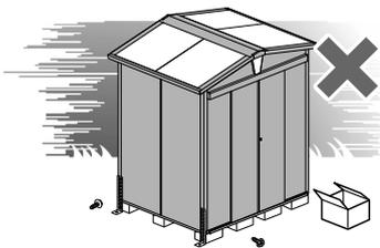
風の強い日は、施工を避けてください。部材が転倒して破損したり、飛ばされた部品でケガをする恐れもあります。
