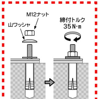
●この後、土台枠の水平を確認して、アンカーボルトのナットとワッシャの間に山ワッシャを入れ、山ワッシャがつぶれるまで締め付け、さらに、もう1回転締め付けてください。(P7・8:「アンカー施工の要領」参照)
