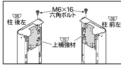
1. 柱の上部に上補強材を取り付けてください。
