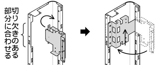
図のように、上補強材を柱の内側に引っ掛けて、切り欠きのある部分にはめ込み、上へ押し上げてネジ止めします。
