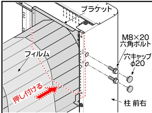
1. ブラケットの下部を、レール取付枠に押し付けながら、M8×20六角ボルトでネジ止めしてください。すぎ間があると、シャッターを正常に開閉できません。
