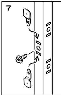
7. 壁パネル同士と柱への取付は、ネジ板を使用してネジ止めしてください。
