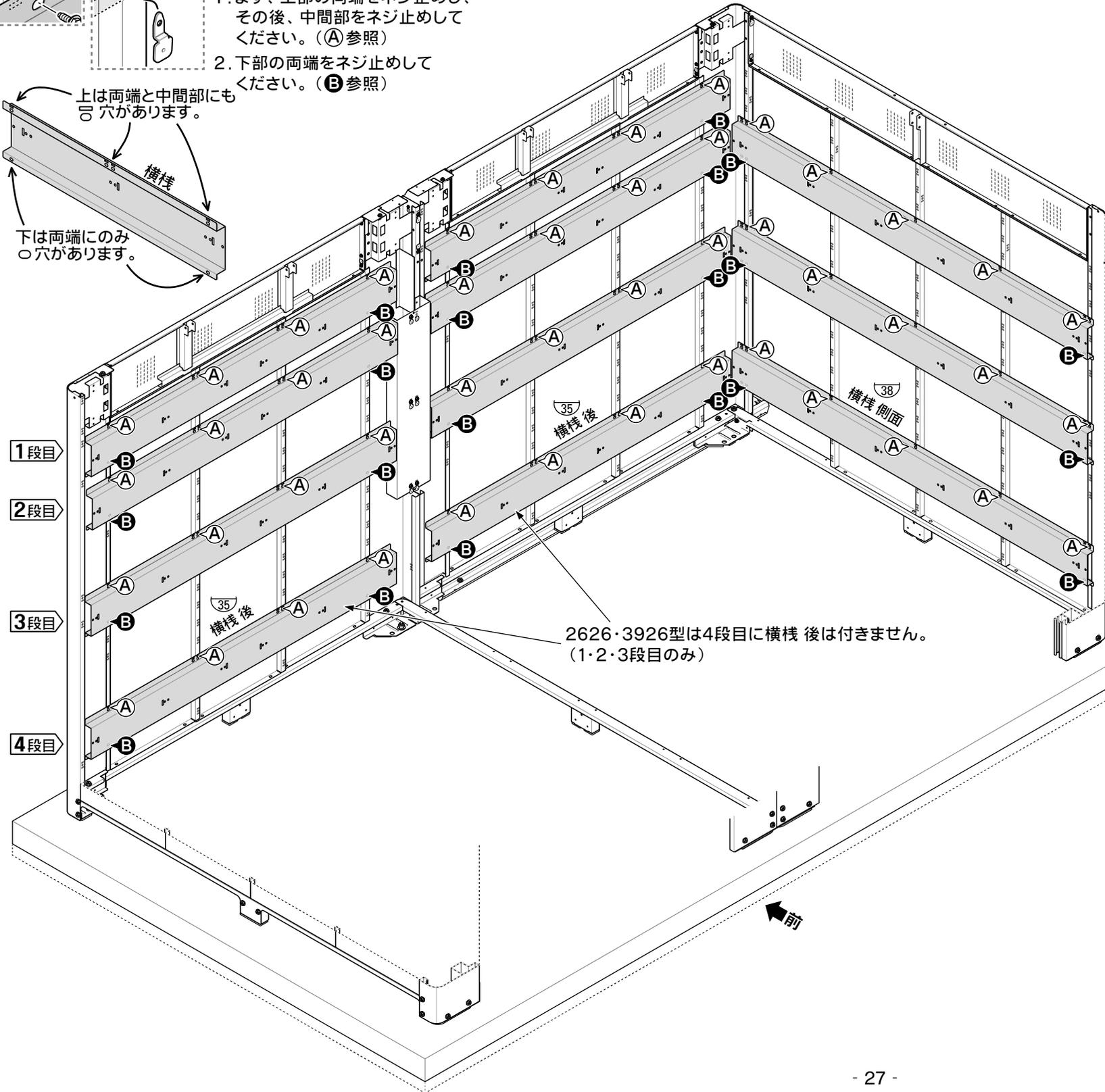
●横棧は、柱の○穴に高さを合わせて取り付けます。
