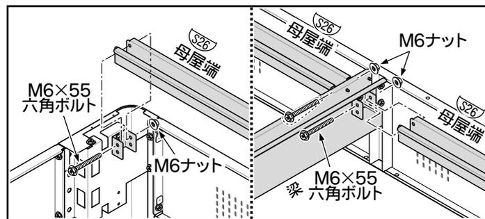
6. 母屋取付金具と前上枠・後上枠の金具に、母屋をネジ止めしてください。(母屋取付金具と後上枠の金具には、穴が上下2ヶ所ずつありますが上の穴のみ使用します。)
