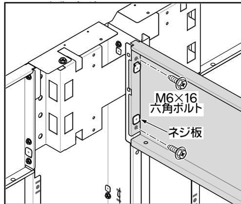
5. 柱連棟上部の上補強材もネジ止めしてください。
