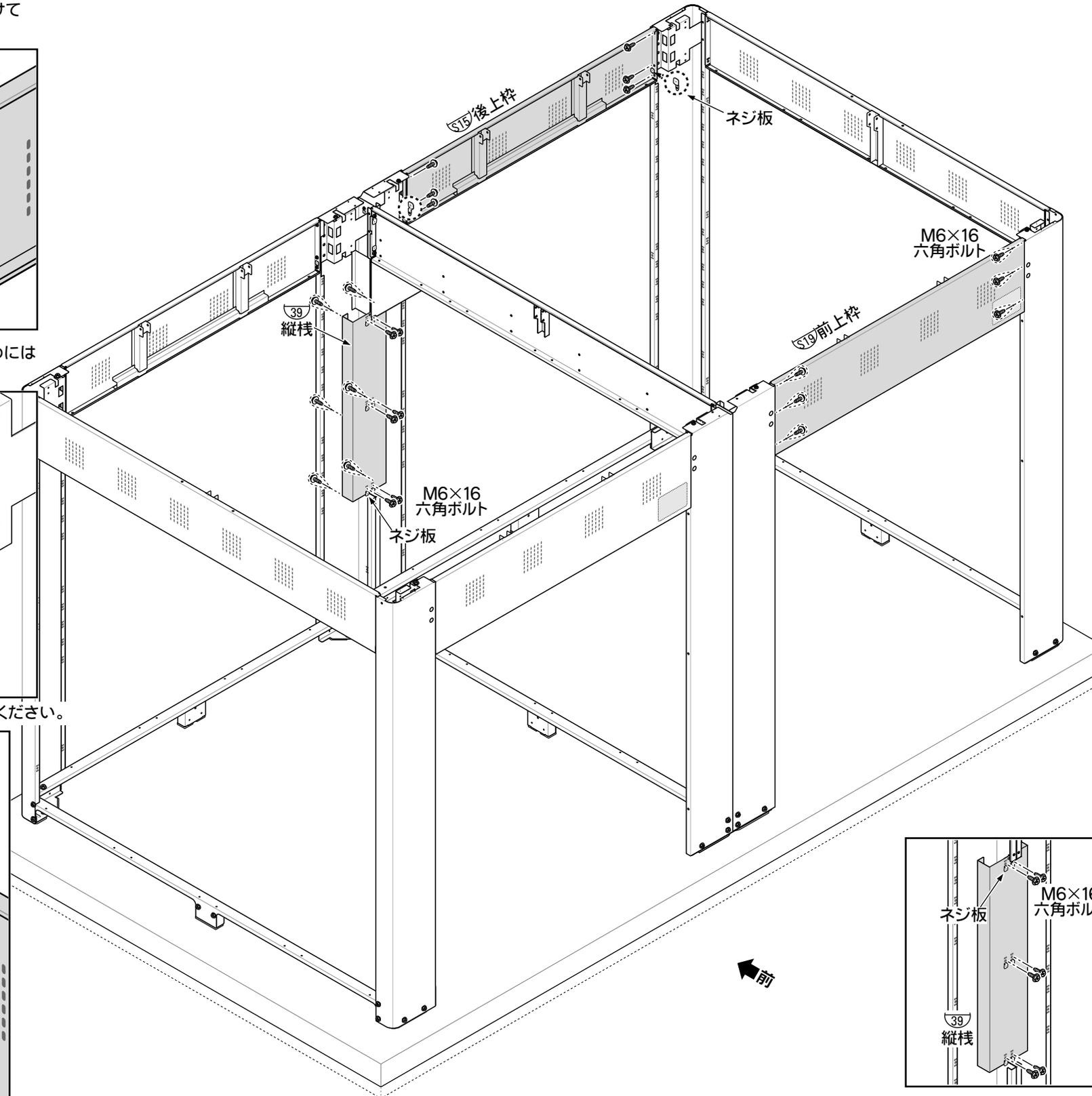
4. 縦棧を柱後連棟にネジ止めしてください。前側のネジ止めにはネジ板を使用します。
