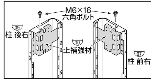
1. 柱の上部に上補強材を取り付けてください。
