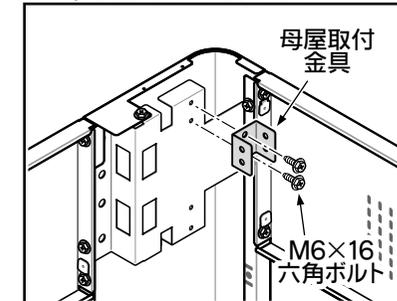
4. 側面上枠の金具に、梁を取り付けてください。
