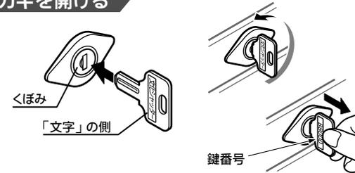
カギ穴のくぼみと、「文化シャッター」の文字の側を合わせてカギを差し込み、反時計回りに半回転させます。必ず、カギを抜いてからシャッターを開けてください。
