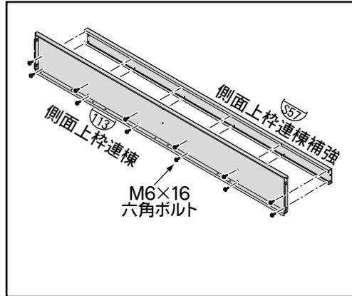
2. 側面上枠連棟に梁取付金具を取り付けてください。
