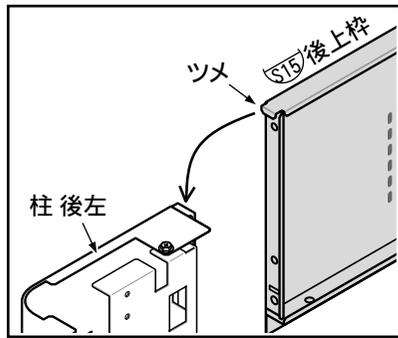
2. 後上枠のいちばん下と側面上枠のネジ止めにはネジ板を使用します。
