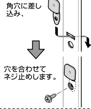
柱後連棟左(108)と柱後連棟右(109)をネジ止めしてください。(柱前連棟左(106)と柱前連棟右(107)も同様にネジ止めしてください。)
