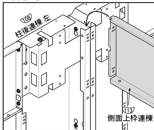
4. 側面上枠連棟のネジ止めには、ネジ板を使い、**仮止め**してください。
