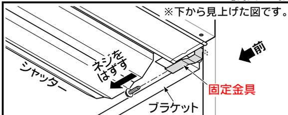
ガイドレールを取り付ける前に、シャッターの**固定金具**を取り除いてください。(上図参照)
