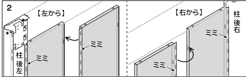
2. 壁パネルは、左右どちらからでも並べられますが、ミミの部分から先に取り付けて、同じ向きに連結してください。
