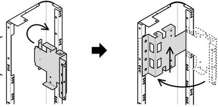
図のように、上補強材を柱の内側に引っ掛けて、切り欠きのある部分にはめ込み、上へ押し上げてネジ止めします。
