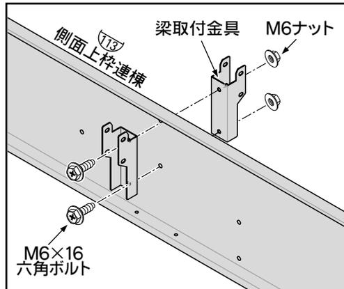
3. 側面上枠連棟を、ツメで柱に引っ掛けてください。
