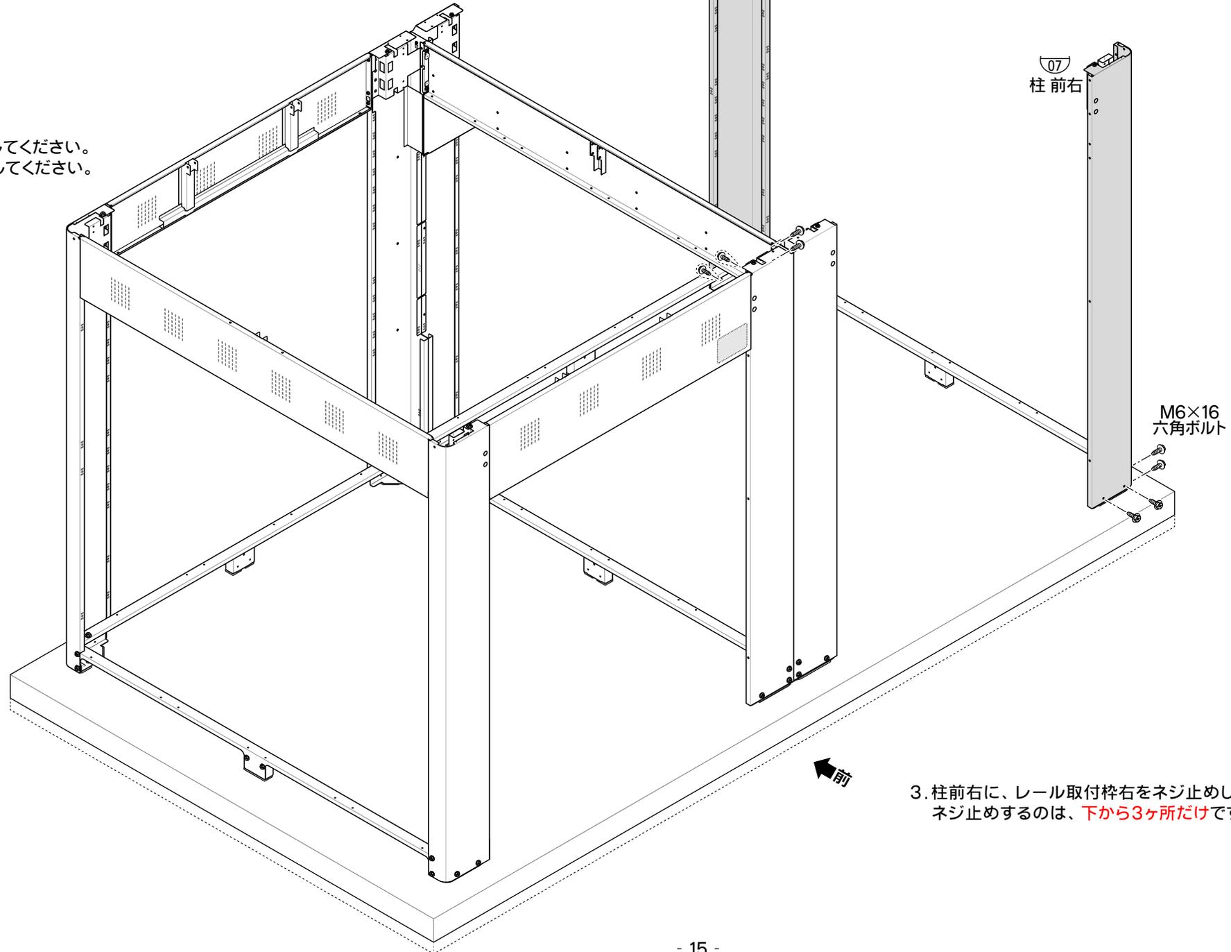
3. 柱前右に、レール取付枠右をネジ止めしてください。
