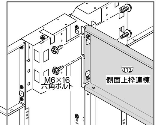
6. コーナー金具大を側面上枠連棟と柱後連棟左にネジ止めしてください。
