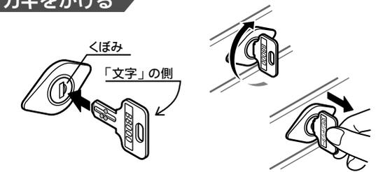
カギ穴のくぼみと、「文化シャッター」の文字の側を合わせてカギを差し込み、時計回りに半回転させます。施錠後は、必ずカギを抜いてください。
