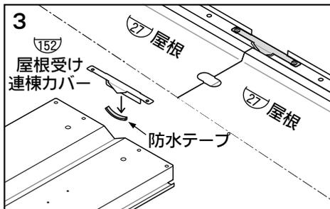
2. 屋根受け連棟カバーに防水テープを貼ってから、屋根にネジ止めしてください。
