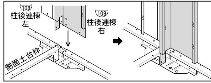
2. 柱後連棟右を側面土台枠の右側にかぶせます。
