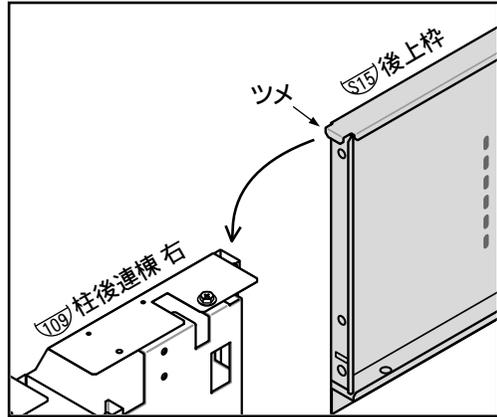
2. 後上枠の場合、いちばん下のネジ止めにはネジ板を使用します。
