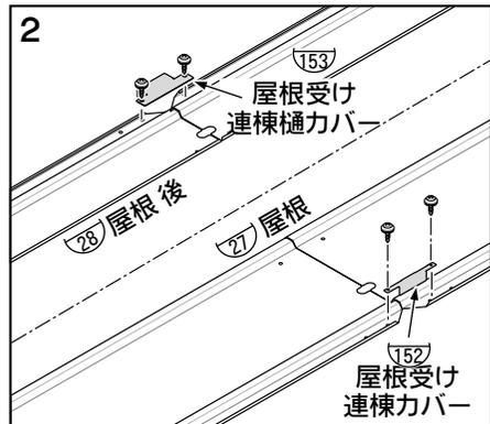
2. 屋根受け連棟カバーと屋根受け連棟樋カバーは屋根の上に設置してください。(屋根の下に設置してしまうと雨漏りの原因となります。)
