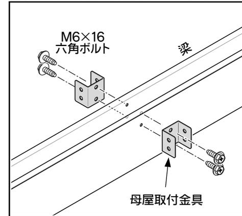
3. 柱上部の上補強材に母屋取付金具をネジ止めしてください。
