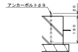
アンカーボルト埋設図 S=1:10
