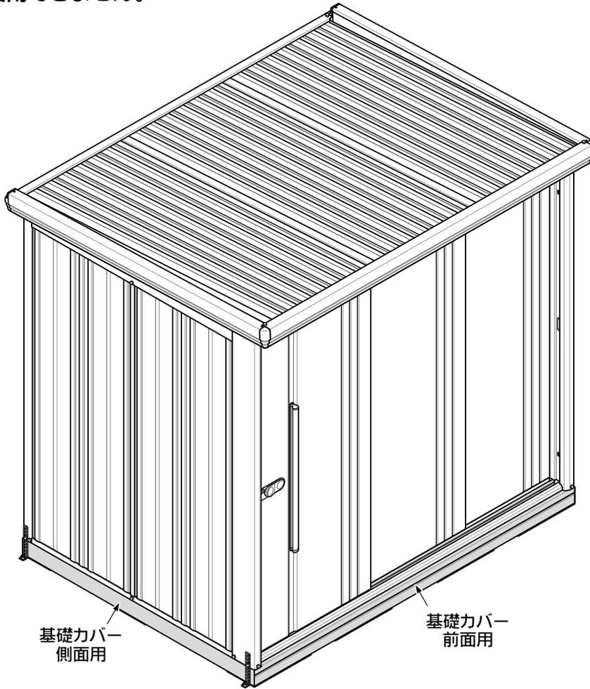
1. 物置本体の組立説明書の〔3〕基礎図で、最前列（出入口側）のブロック位置を後側に10mm程度ずらします。（前面用のみ）
