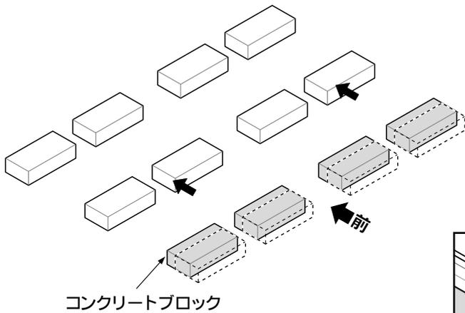
2. 基礎カバーを前面用、側面用の順に置き、その上に床枠を並べて物置本体を組み立ててください。
